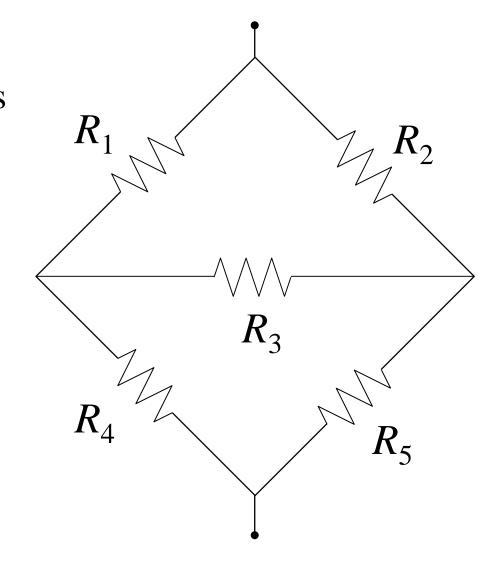
$$R_{eq} = \frac{R_1 R_2 R_3 + R_1 R_2 R_4 + R_1 R_2 R_5 + R_1 R_3 R_5 + R_1 R_4 R_5 + R_2 R_3 R_4 + R_2 R_4 R_5 + R_3 R_4 R_5}{R_1 R_3 + R_1 R_4 + R_1 R_5 + R_2 R_3 + R_2 R_4 + R_2 R_5 + R_3 R_4 + R_3 R_5}$$
